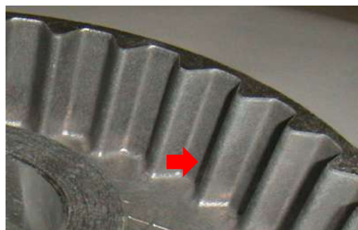
➡ スプライン部は抜き勾配1° (加工レス達成)
