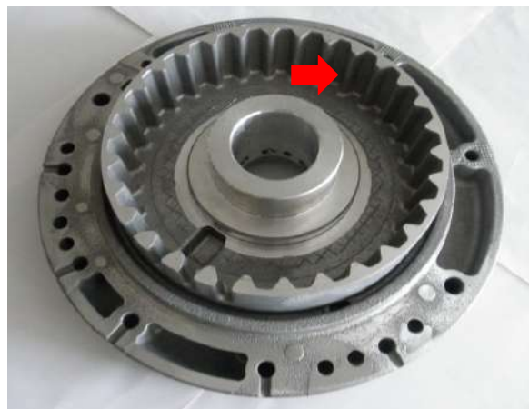
➡ スプライン部は抜き勾配1° (加工レス達成)
